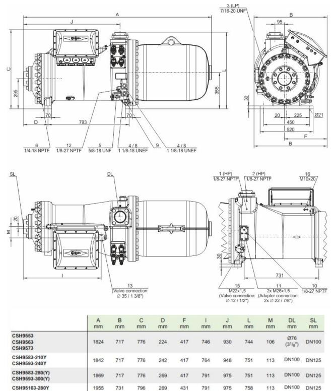
Die Verwendung größerer Sauggasflansche führt zu längeren Maßen A, D und J. Using larger suction gas flanges changes the dimensions A, D and J.
