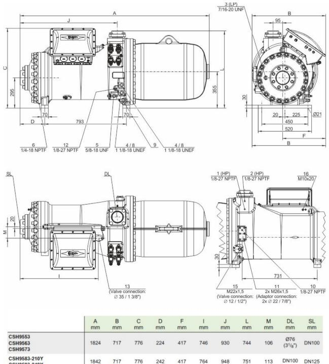
CSH9593-240Y CSH9583-280(Y) **DN100** DN125 1869 717 776 269 417 791 975 751 113 CSH9593-300(Y) CSH95103-280Y **DN100** 1955 731 796 269 431 791 975 758 113 **DN125** CSH95103-320(Y) DN100 DN125 1975 731 796 289 431 810 995 758 113 CSH95113-320Y
